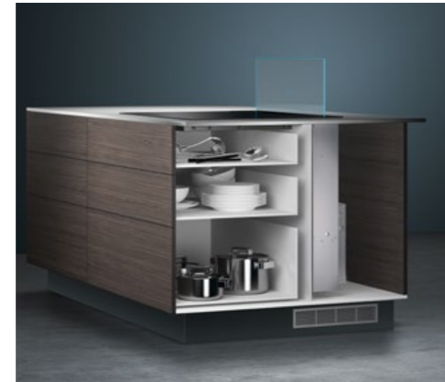
Sistema ricircolo. Un kit di ricircolo pulisce l'aria con un filtro a carbone attivo. Il kit contiene anche un breve pezzo di condotto tondo per guidare l'aria sotto lo zoccolo. Per garantire la necessaria apertura di sfogo di 400 cm 2 è possibile inserire una griglia di ventilazione alla base del mobile o accorciare lo zoccolo dell'intero mobile.
